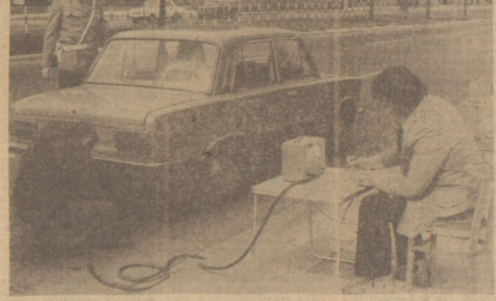
(P) Badania regulacji gaznika przy pomocy analizatora spalin
