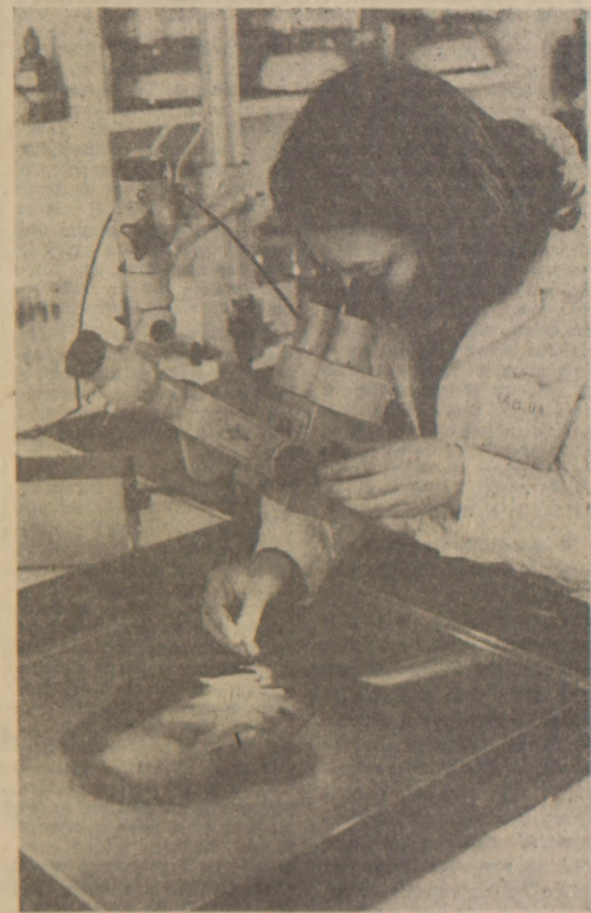
Mikroskop ze sterowanym światłem punktowym pomaga w kontrolowaniu pola obrazu, z którego zdjęcie jest uszkodzone warstwą farby.
