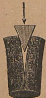
Fig. 9. Klin. działywanie sprężyste boków klina, tak iż siła poruszająca, wywiera na jego głowę, ma do zrównoważenia tylko pozostałą część oporu. Wielkość potrzebnej siły poruszającej tak się ma do wielkości całego oporu, jak szerokość klina do jego długości.
