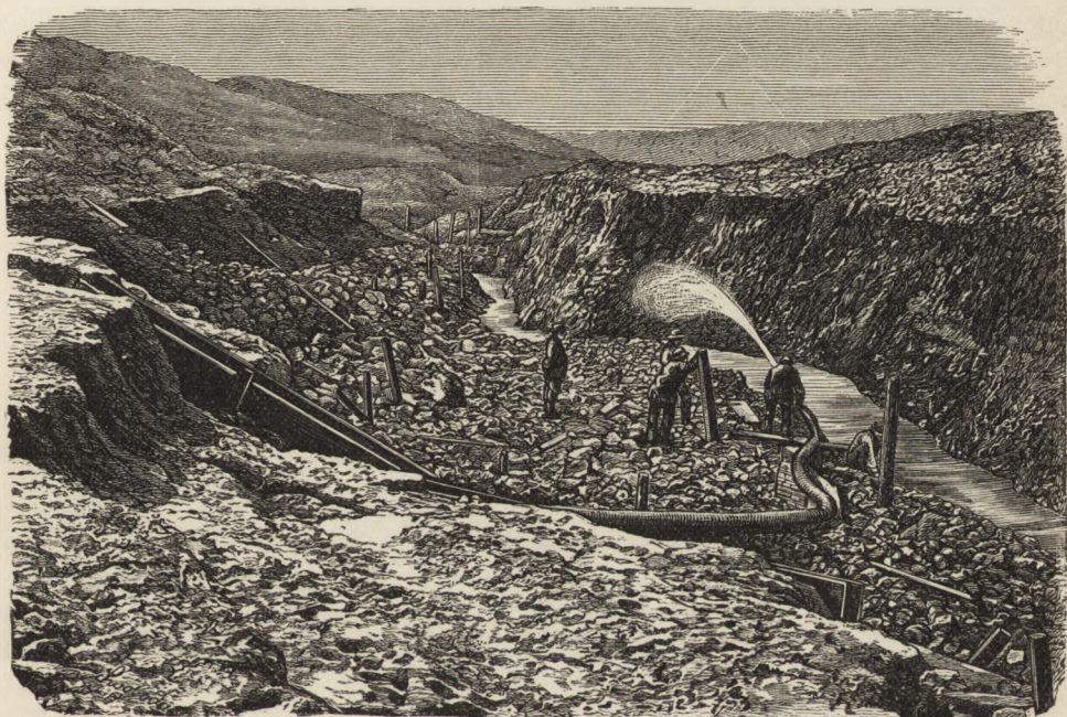
Рис. 663. Гидравлическій способъ промывки золота въ Монтанѣ въ Сѣв. Америкѣ. (По фотографіи.)
